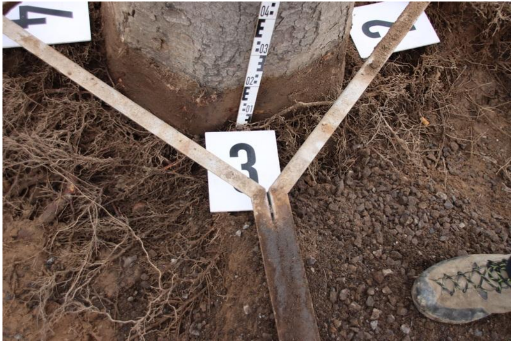
Abb. 8: Detailansicht auf die Überfüllung des Stammfußes bei Messung 3. Der Stammfuß ist bis zu 20 cm überfüllt.
