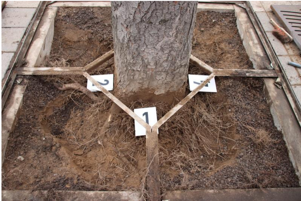
Abb. 6: Gesamtansicht auf die freigelegten Wurzelanläufe der Kataster-Nr. 164. Aufgrund der festgestellten Überfüllung wurden die Wurzelanläufe freigelegt und eine Eingehende Baumuntersuchung durchgeführt. Es erfolgten vier Messungen mit dem Resi PD 400. Die Nummernschilder kennzeichnen die Lage der Messungen.
