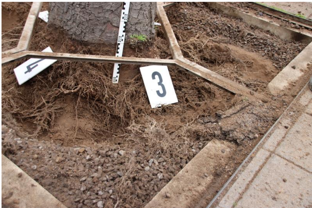
Abb. 36: Detailansicht auf die freigelegte Baumscheibe bei den Messungen Nr. 3 und 4. Ein hohes Wurzelvorkommen von intakten Haar- bis Schwachwurzeln ist erkennbar. Die Überfüllung im Messbereich Nr. 3 beträgt 20 cm.
