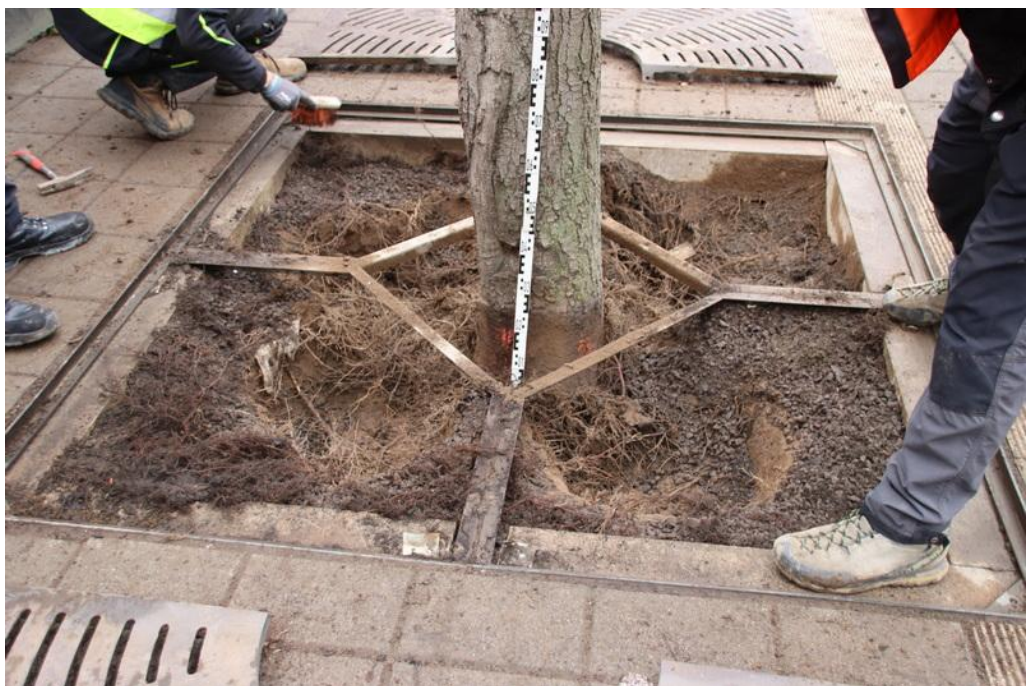
Abb. 18: Ansicht auf die freigelegte Baumscheibe bei den Messungen 3 und 4. Ein hohes Wurzelvorkommen von intakten Haar- bis Schwachwurzeln ist erkennbar. Die Überfüllung bei Messung Nr. 4 beträgt 25 cm.
