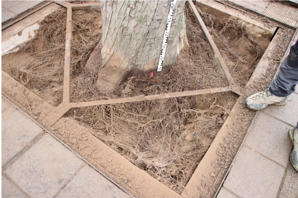
Abb. 26: Detailansicht auf den Bereich der Messung Nr. 3 mit dem Resi PD 400. Die Überfüllung ist deutlich erkennbar. Auch hier kann ein starkes Wurzelvorkommen verzeichnet werden. Die Wurzeln sind allesamt intakt.
