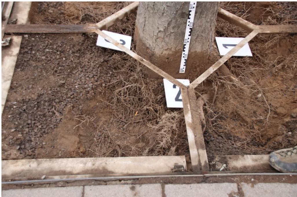
Abb. 7: Ansicht auf das Wurzelvorkommen im Bereich von Messung Nr. 2. Es ist im gesamten geöffneten Bereich ein hohes Wurzelvorkommen an Haar- bis Schwachwurzeln sichtbar. Die Wurzeln sind intakt.
