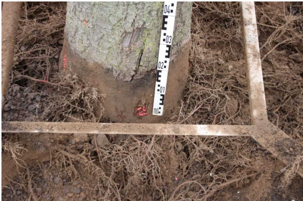
Abb. 16: Detailansicht auf den Messpunkt Nr. 2 am freigelegten Stammfuß der Rosskastanie. Es wurden vier Messungen am Stammfuß des Baumes getätigt. Die Messnummer wurde mit einem Permanent Marker auf den Stammfuß geschrieben. Die Überfüllung ist deutlich sichtbar und beträgt hier 20 cm.
