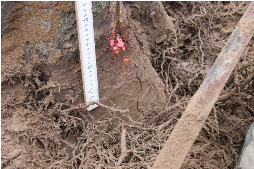
Abb. 27: Detailansicht auf den Bereich der Messung Nr. 4. Die Überfüllung des Stammfußes liegt bei 15 cm.
